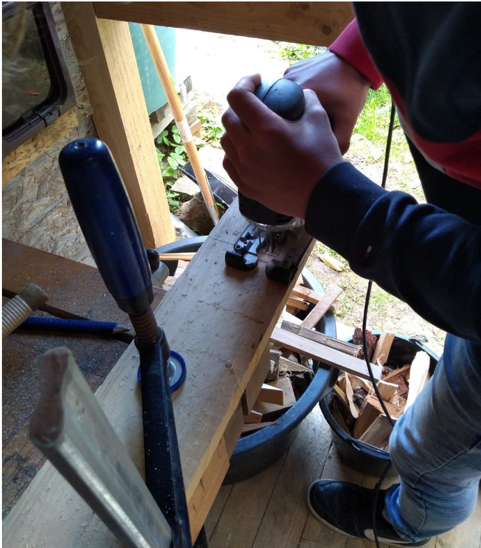
Zuschnitt der Bretter mit einer elektrischen Stichsäge
